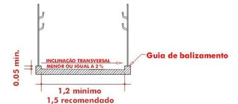
Inclinação transversal e largura de rampa
